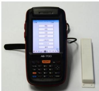
图 5.8 RFID 射频读码器
