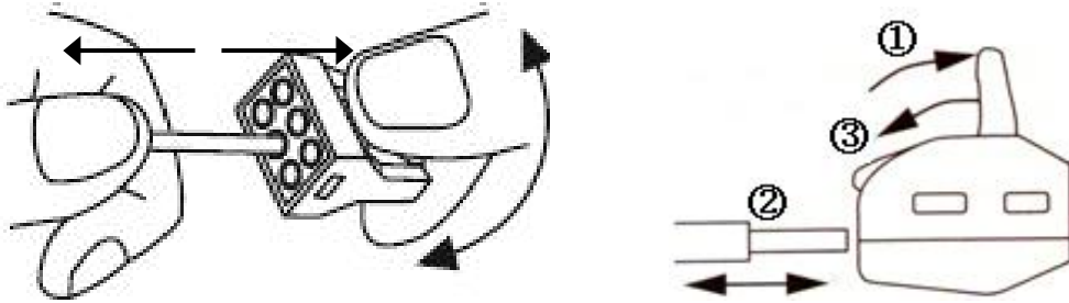
图 6.3.1 推线式连接器的导线安装或拆卸示意图 图 6.3.2 通用型连接器的导线安装或拆卸示意图
