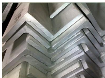
图 5.7.4 热浸镀锌防腐施工
